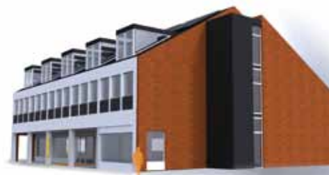
På gavlen ses den 'grønne' elevator, der laver strøm, når den kører ned.
