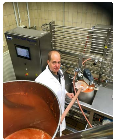
Tobias Schardt pasteuriserer gulerodsjuicen på en pilot pasteur.
