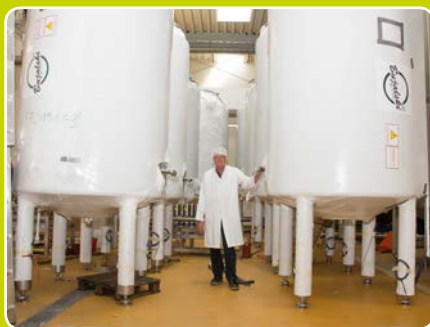
De største af tankene rummer 40 kubikmeter, mens de mindre rummer henholdsvis 10 og 5 kubikmeter.
